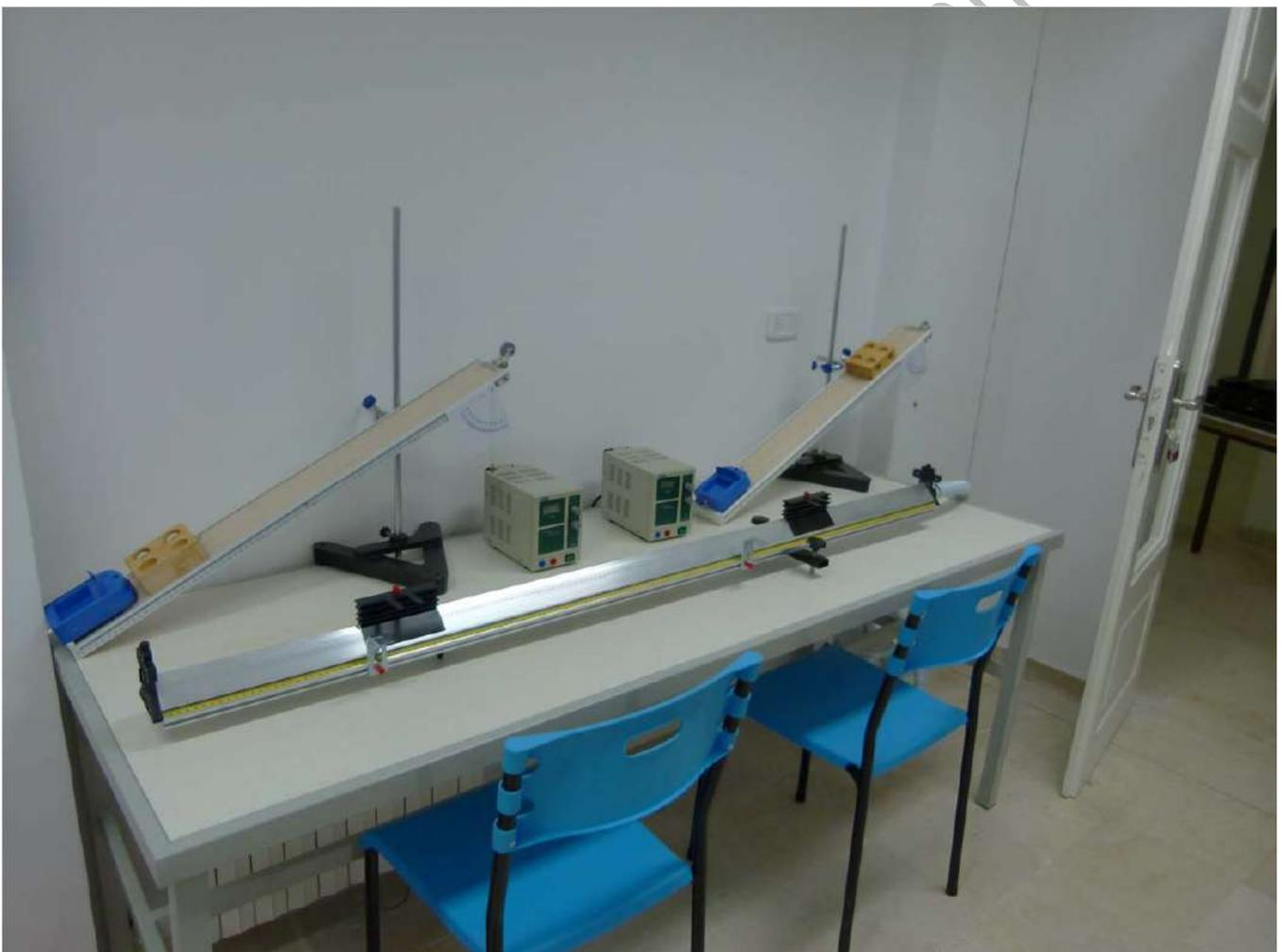
Appareil comprenant un rail rigide, muni d'une règle graduée au mm sur une distance de 180 à 200 cm , un chariot à roulement à billes adapté au rail et pouvant recevoir une charge, un dispositif de freinage et d'arrêt du chariot à la fin de sa course, une bille d'acier inoxydable, un électroaimant (alimenté par une tension continue comprise entre 6V et 12V) pour la libération du chariot ou de la bille d'acier, un socle assurant une stabilité sûre et muni de vis calantes, un
